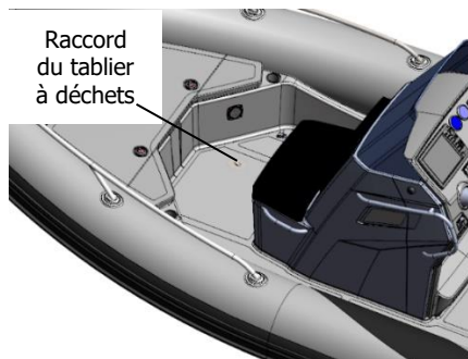
Fig. 51. Emplacement du raccord du tablier à déchets.
