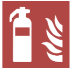
Fig. 11. Symbole de l'emplacement désigné de l'extincteur portatif.
